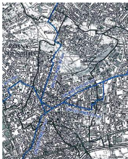
Canalisations de transport de matières dangereuses sous pression Source: PAC de la Préfecture
